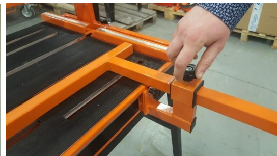
następnie zablokować za pomocą pokręteł
