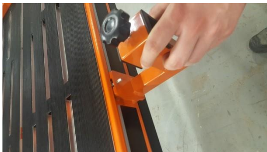
Wsunąć oba wsporniki prowadnicy i zablokować za pomocą pokręteł
